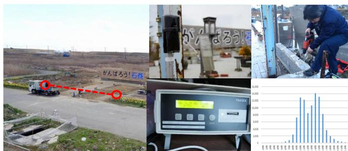
図1 開発した「がんばろう 石巻」看板の来訪者数自動計測システムとモニタリング結果例
