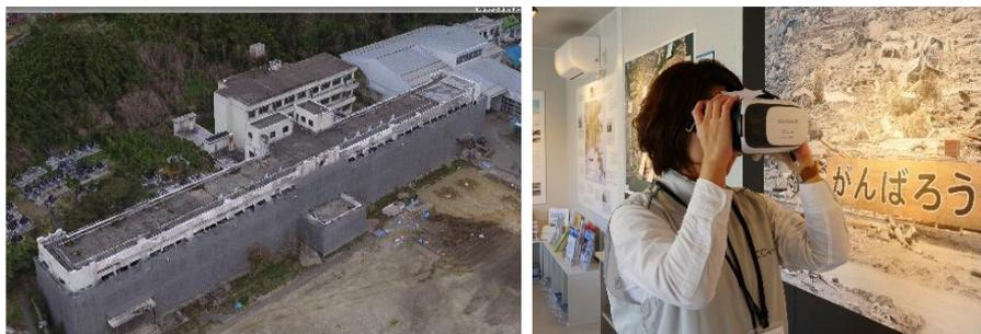
図5 震災遺構の3Dモデル化とVRでの可視化実装（左側図は、写真ではなく、3Dポリゴンに写真テキストチャを貼り付けたモデル）
