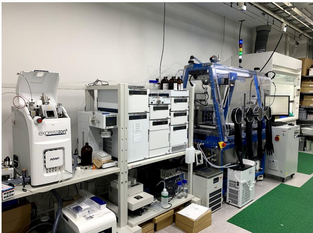
図： ICreDDのMix-Labに設置した、新たな化学反応の迅速な検証を可能とする、有機合成用に設計された自動化学合成装置
