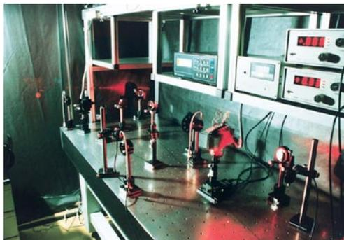
図5. フォトリフラクティブ効果評価システム
