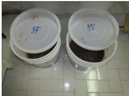
種汚泥保存状況
