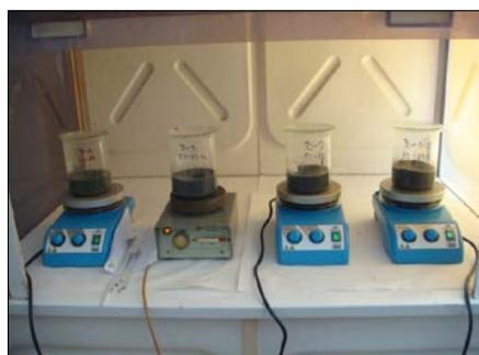
4. 試験状況 1(浸出試験)
