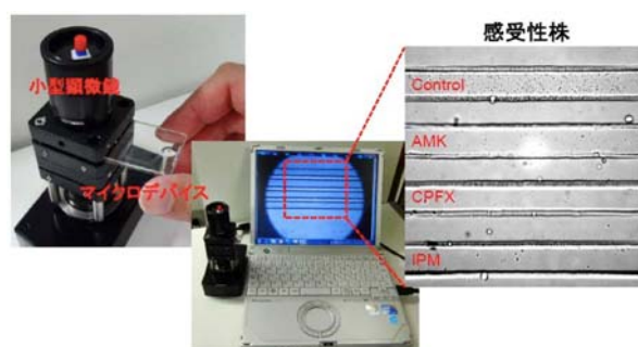
図6. マイクロデバイスを用いた薬剤感受性試験。迅速に細菌の薬剤感受性を測定することに成功した。
