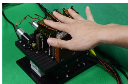
図6 複数指全体に柔軟感を提示する多指柔軟触感ディスプレイ
