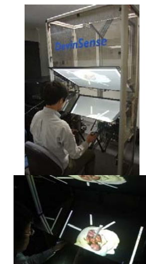
図 6 没入型ディスプレイと6自由度ハプティックデバイスへの実装
