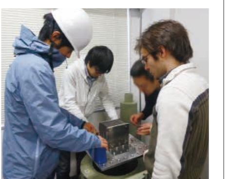
ChubuSat実践プログラムにおいて学生が設計した観測装置の構造を振動試験
