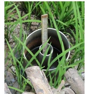
図1 手製の地下水位計
