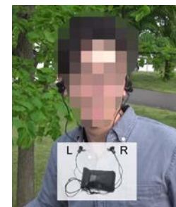
図1 左右反転聴空間をつくり出すウェアラブルシステム [Aoyama (J Vis Exp, 2018) より一部改変]
