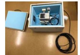
図3 シベリア域に設置予定の自動温度調節断熱ボックスに入った小型PM 2.5 センサー。
