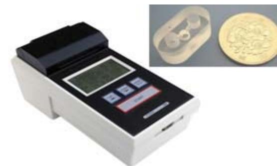
図3 実用化されたハンディー元素分析装置(MH-5000)と、石英チップ。
