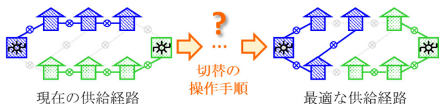
図 1. 配電制御の例
