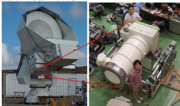
図1 現在 POLARBEAR プロジェクトで使用中の電波望遠鏡(左)および、開発中の POLARBEAR-2 検出器システム(右)。
