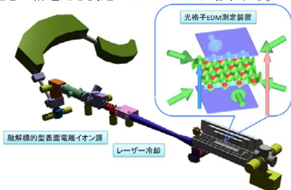
図1 レーザー冷却光格子EDM測定装置
