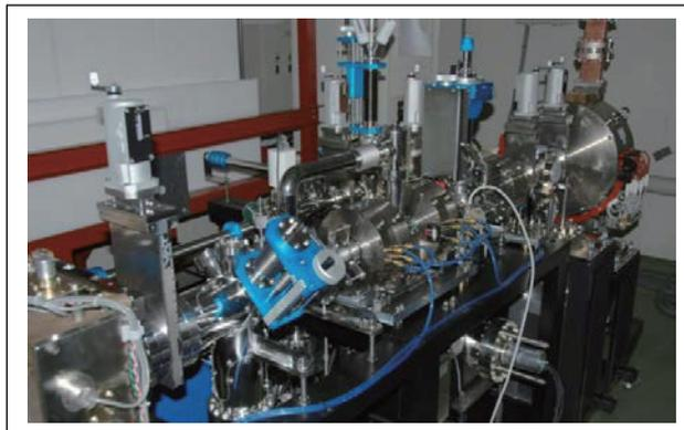
図1 フェムト秒時間分解電子回折装置
