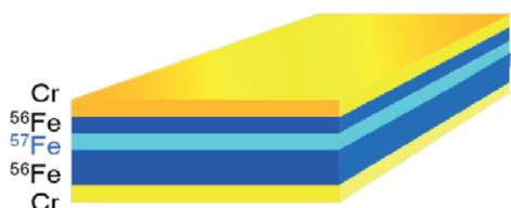
図2. Fe層をメスバウアー効果に感度のある<sup>57</sup>Feで同位体置換を行ったFe-Cr多層膜
