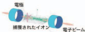
加電圧の制御でイオンの入射、捕獲及び吐き出しが自由に制御できるので、短寿命の原子核を標的とすることが出来るわけです。
