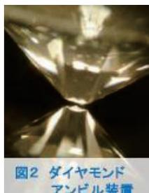
図2 ダイヤモンドアンビル装置
