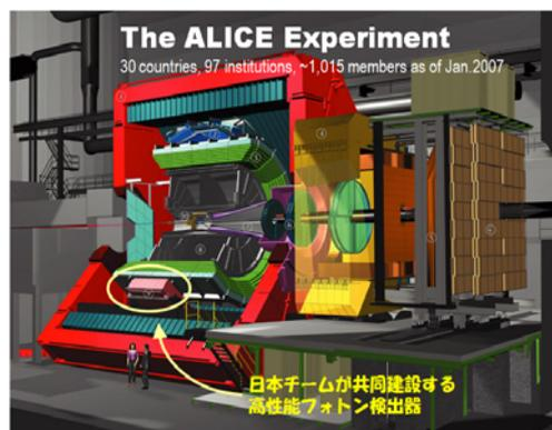
電荷感応型増幅器など、光子検出読出系の開発及び国内生産を実施した。PHOS は同型のモジュール 5 基から構成し、各モジュールには 3,584 本の PWO 検出素子を  $56 \times 64$  の格子状に配置し、ビーム衝突位置から約 5m の距離に設置する。従来のシンチレーション材に比較してモジュール半径が小さく高性能な PWO 結晶、及び優れた光子検出方式を新規開発したこと、並びにこれらの性能を更に高める低温運用技術を開発したことにより、中性パイ中間子識別限界運動量を 80GeV、エネルギー分解能を約  $3\%/\sqrt{E}(\text{GeV})$  にまで向上することに成功し、従来の実験研究に比較して格段に高度で詳細なフォトン物理推進を可能にした。
