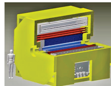
図4 本特別研究研究で作成するスペクトロメータ概念図。大型超伝導ソレノイド(白で図示)内部に円筒型ドリフトチェンバー(青)を配置し、中性子検出器兼ポリアリメータ(赤)で標的物質を覆うことで、効率的にK中間子原子核の性質を解明する。
