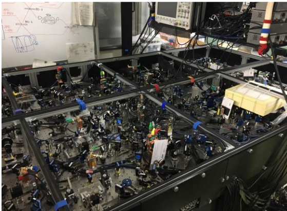
図4 図3のセットアップを実現。時間無制限2次元大規模連続量クラスター状態の生成に成功。
