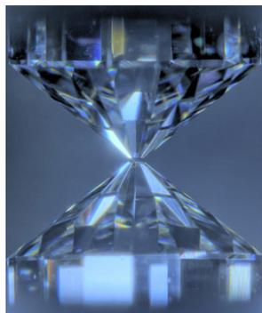
図1 DAC 超高压発生装置
