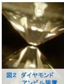
さらに、SPring-8のBL10XUに加えて大阪大学との研究協力により、ダイヤモンドアンビル面に高温負荷の小さいパルス加熱とX線回折法を用いて、高温高压下でのX線その場観察実験により地球中心条件を恒常的に発生し、そこでのX線回折を可能にする。
