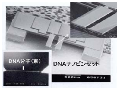
図1 ナノピンセットの顕微鏡像と、針先に捕らえたDNA分子の束
