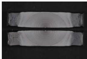
写真2 表面き裂試験片の破面
