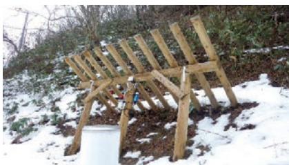
(a) 間伐材を用いた計測柵の実装
