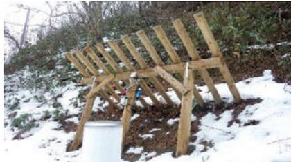
(a) 間伐材を用いた計測柵の実装
