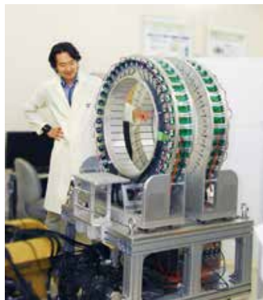
図3 科研費事業による実証結果を元にスケールアップしたOpenPET試作機。
