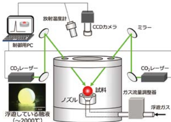
図1 ガス浮遊炉
