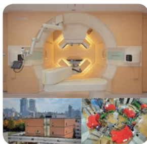
図2 FIRSTで開発した世界初の動体追跡スポットスキャン陽子線治療装置と北海道大学病院陽子線治療センター
