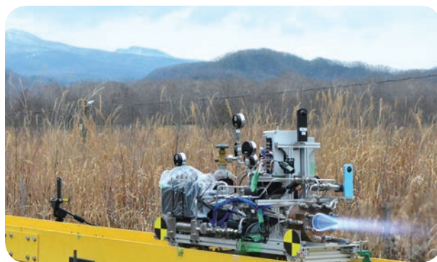
図2 回転デトネーションエンジンの滑走試験
