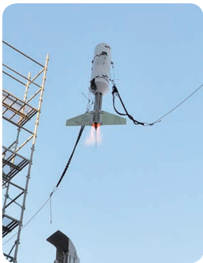
図1 パルスデトネーションエンジンの飛行試験
