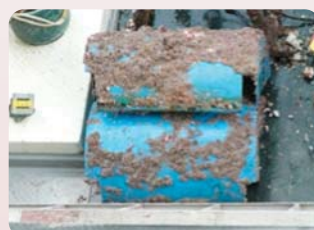
図1 設置から17か月後の水車への付着生物の状況
