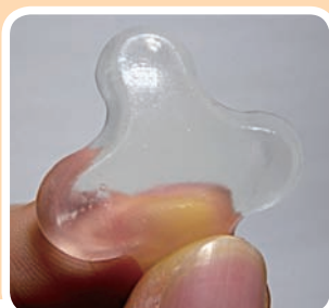
◀図2 アクアマテリアル：ほとんどが水であるが、成形加工ができるほど強い強度を示す。
