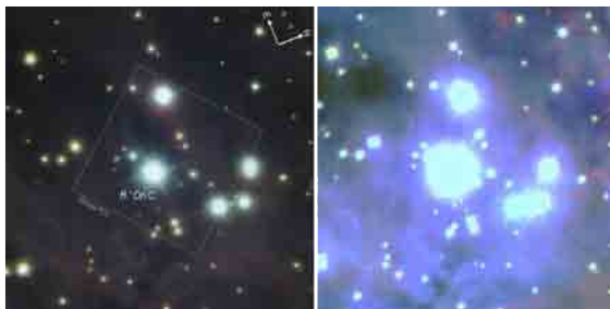
188素子補償光学系はすばる望遠鏡の従来の空間解像力 (右) を10倍に改善 (左)
