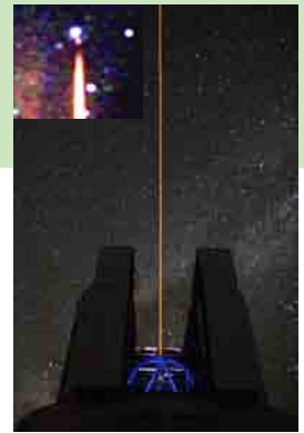
新補償光学系を支援する人工星 (左上のレーザービーム先端の赤い星) 生成装置を開発
