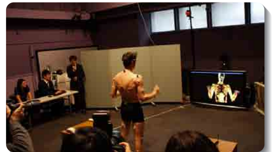
図2 筋肉のグルーピング、低次元モデル(62自由度の骨格モデル、308本の筋肉モデル)、並列処理によるリアルタイム可視化(描画16フレーム毎秒)。サイバービヘイビアスタジオにおける公開実験
