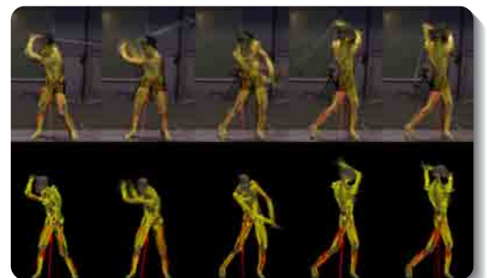
図3 マジックミラー:実ビデオ映像に筋肉の張力をカラー表示した画像をオーバーレイすることで自分の筋肉を透けて見るような体験ができる
