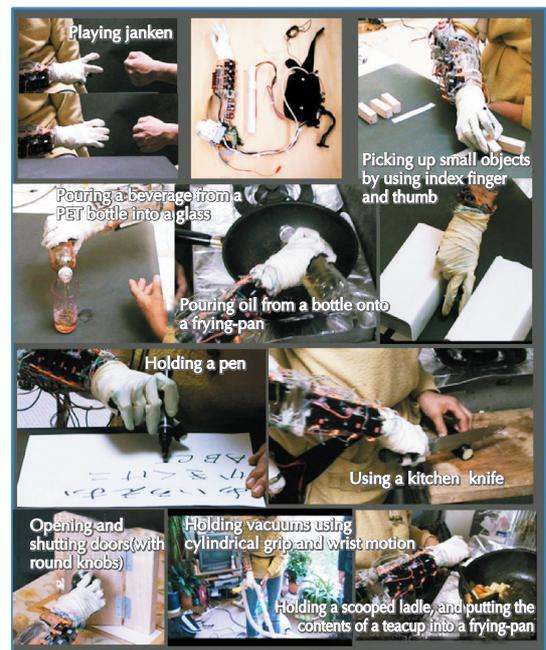
図2 個性適応型筋電義手
