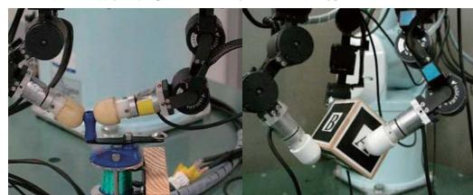
(a) 釣竿用リールの回し動作 (b) 多面体物体の持ち上げ状態での操り
