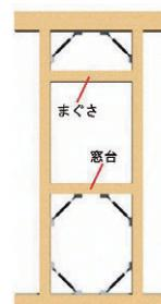
図3 軸組みへのダンパの設置状況
