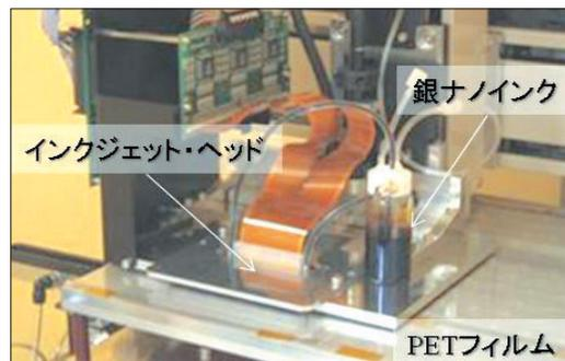
図1 配線に用いたインクジェット印刷機
