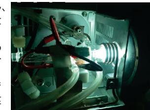
図3 高温プラズマ質量分析装置
