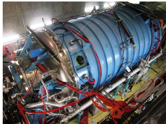
ク内部に配置され、 $\pi^0$ 中間子の崩壊による2個の $\gamma$ 線のみを検出することで探索を行う。現在のKOTO実験での最大の背景事象は、中性K中間子の代わりに、荷電K中間子が上流から検出器に入ることで起こる。検出器上流部のビーム中に非常に薄い荷電粒子検出器を設置し、荷電K中間子を検出することで、この背景事象を削減する。今回、200 $\mu\text{m}$ 厚プラスチックシンチレータからなる非常に薄い検出器を新たに開発し、設置する。この他にも検出器を改良し、データ取得システムを刷新し、これまでに比べ10倍高い探索感度で実験を行う。
