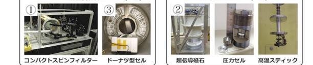
J-PARCに設置した高エネルギー中性子分光器POLANOと本研究で導入するSEOP偏極解析システムおよび多重外場発生システム。
