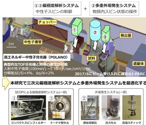
J-PARCに設置した高エネルギー中性子分光器POLANOと本研究で導入するSEOP偏極度解析システムおよび多重外場発生システム。
