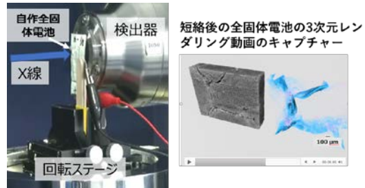
図4 X線CTを用いた全固体電池の解析例
