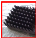
3Dプリンタ技術 を応用した電波 吸収材“黒体”
