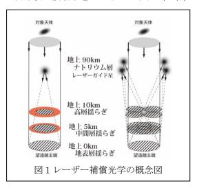
天体からの光は円筒状の大気を通ってやっ てくるという違いがあり(円錐効果)、波面測 定にかからない成分が存在するため、補償光 学の精度が制約されてきた。我々は図1右の ように4個のレーザー光源を用意し、その光 源を4台の波面センサーを搭載したトモグラ フィー波面測定ユニットで測定することで、 天体の光路である円筒状の領域を含む波面 の測定を行い、円錐効果を低減する。この場 合に4方向の測定結果から大気揺らぎの高さ 方向に分解した構造をトモグラフィーの手 法で推定し、対象天体からの光の光路で積分 することで最適な補償を行う。このトモグラ フィー補償光学により、波長が短く、これま では補償が有効でなかった可視光でもレー ザー補償光学が有効となる。
