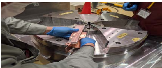
図3. 完成したサイクロトロンのマグネットと RF 空洞の一部。2020 年 J-PARC に設置予定。
