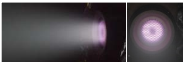
図1 水を推進剤として利用したイオンスラスタの作動
