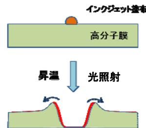
図2 高分子膜の自由界面に存在する異種高分子へテロ界面から誘起される物質移動(模式図)
