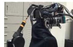
チュエータのバックラッシュレス特性を利用することで、アームに関する誤差を手先機構で高速に補償してタスクを遂行することを可能にした。その結果、通常の力制御を利用したペグインホールに比べて、格段に高速化することを実現した。
