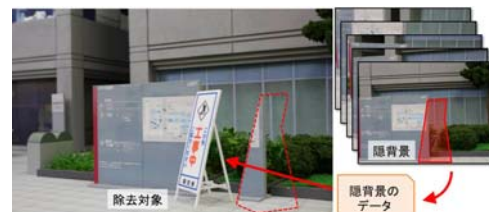
図2 隠背景映像重畳による実物体の消去
