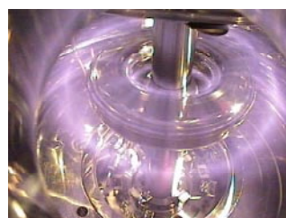
図2. RT-1 プラズマ実験装置。超伝導マグネットを磁気浮上させ、磁気圏型配位を形成して1億度を超える超高温プラズマを閉じ込める。
